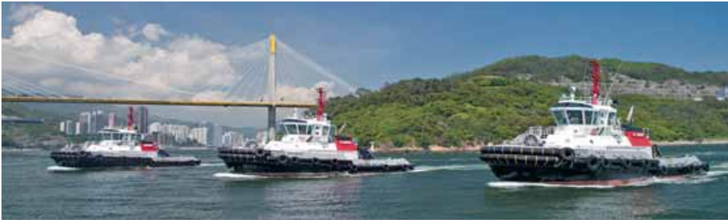
香港聯合船塢集團共訂購四艘五千匹馬力的拖船，於二零一二年接收其中最後兩艘。在香港港口營運的拖船中，這屬最大型的拖船，可提供港口拖船、打撈、滅火及油污控制等服務。
