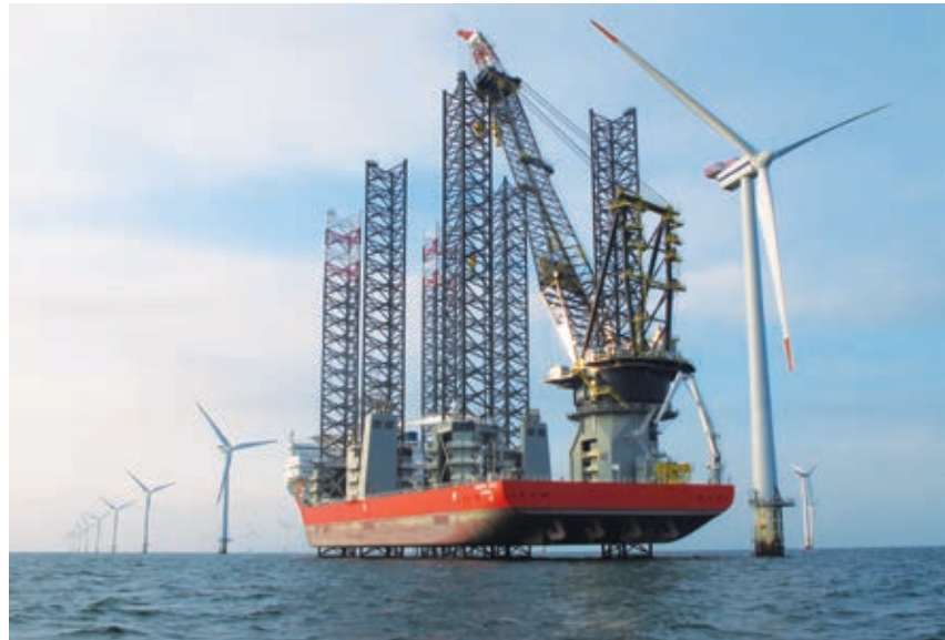
Swire Blue Ocean兩艘分別名為Pacific Osprey號及Pacific Orca號的風力發電站裝置船，專為從事最艱難的離岸建造作業而設計。
